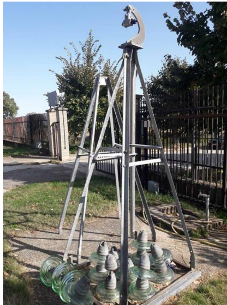
Слика 4. Изглед на монтиран врв за носив столб N 240-50
